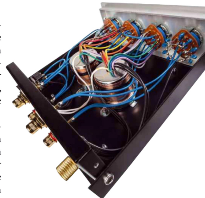
Die vielen einstellbaren Werte führen zu einem etwas unübersichtlichen Leitungsverlauf
